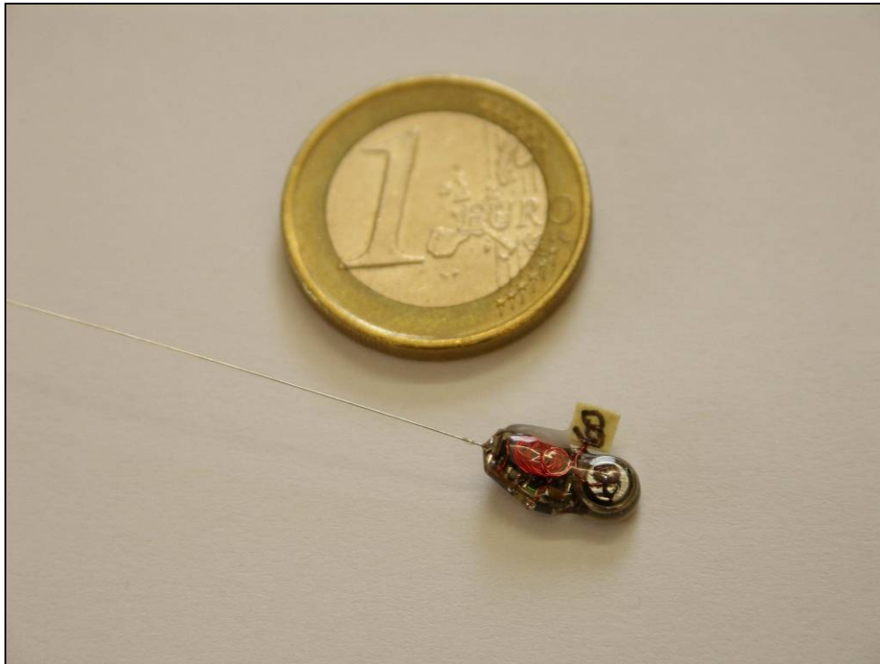
Abb. 2 Radiotelemetrie-Sender der Fa. Holohil (Modell LB-2N) mit einem Gewicht von 0,42 g zur Verwendung für die Untersuchung von Fledermäusen.
