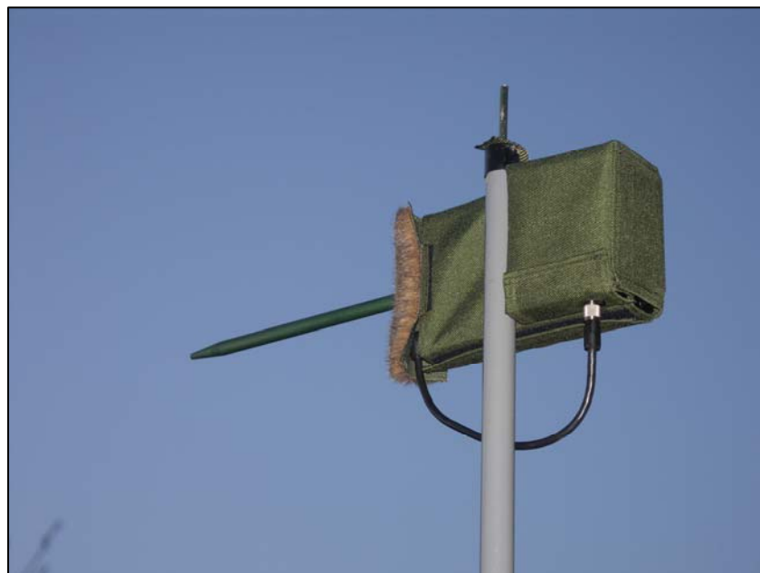
Abb. 3 Automatische Registriereinheit („batcorder“, ecoObs, Nürnberg).
