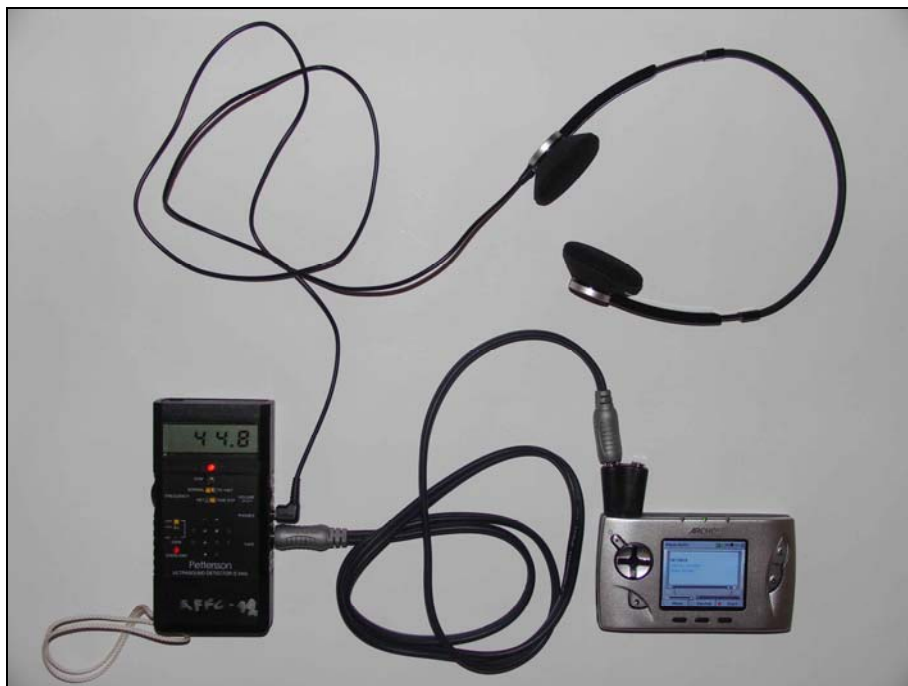
Abb. 1 Setup für die Aufnahme von Fledermaus-Rufen mit Zeitdehnungsdetektor (Pettersson D240x) und MP3-Player (Archos Gmini 400). Foto: G. Reiter
